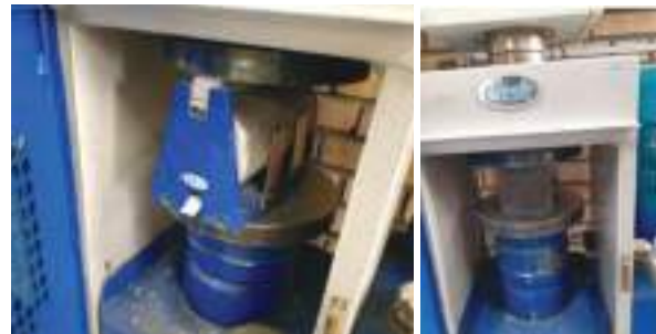
شکل ۴- آزمایش مقاومت کششی بتن به روش برزلی
